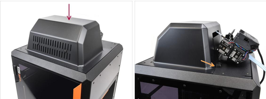
◆ Si utiliza la versión Enclosed, cubre la impresora con la Cubierta Superior.
