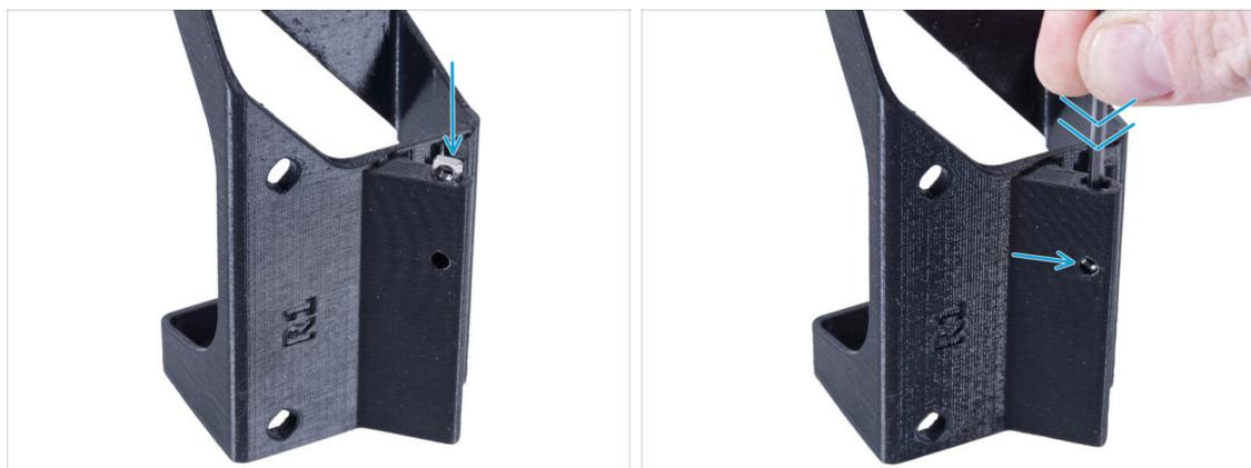
**●** Insérez l'écrou M3nS dans le External-PSU-bracket-XP. À l'aide de la clé Allen, poussez l'écrou à fond dans la pièce imprimée et alignez l'écrou avec le trou de la pièce.
