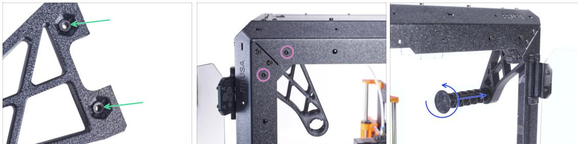
● Insérez complètement deux écrous M3n dans les trous du Spool-holder-r.
