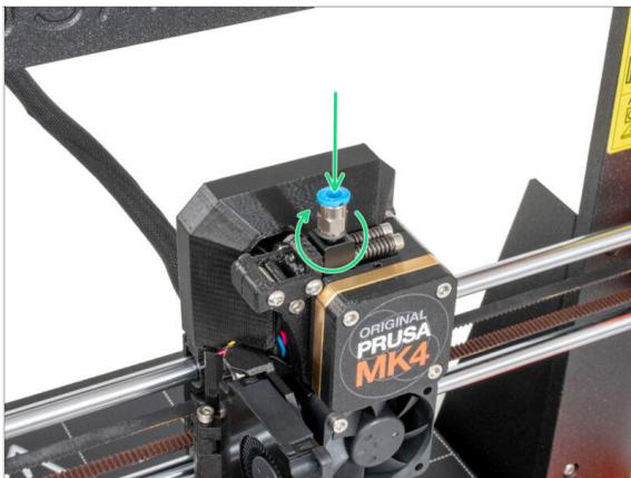
◆ Insérez et vissez le raccord QSM-M5 directement dans le trou de filament fileté de l'extrudeur.
