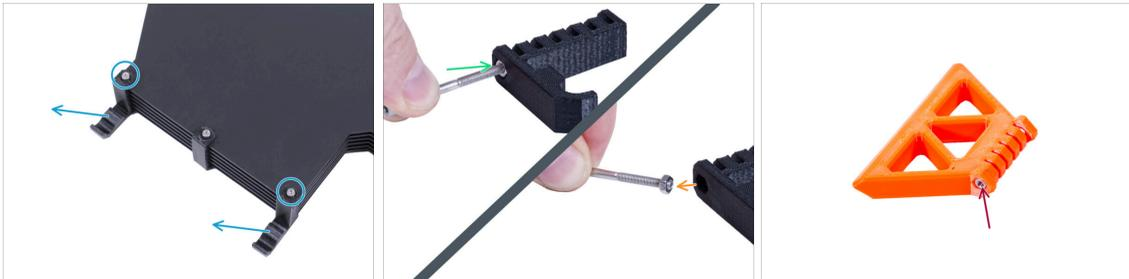
● Desserrez les deux vis fixant le s-buffer-hook-uni et retirez la pièce imprimée du tampon.
