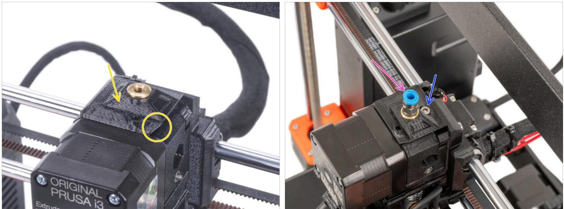
● Fixez le nouveau FS-cover sur l'extrudeur. Regardez la bonne orientation. Le côté biseauté doit être à droite (au-dessus de l'extruder-idler).
