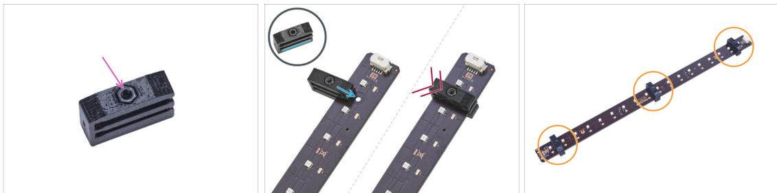
● Insérez l'écrou M3n dans chaque LED Stick Bracket.
