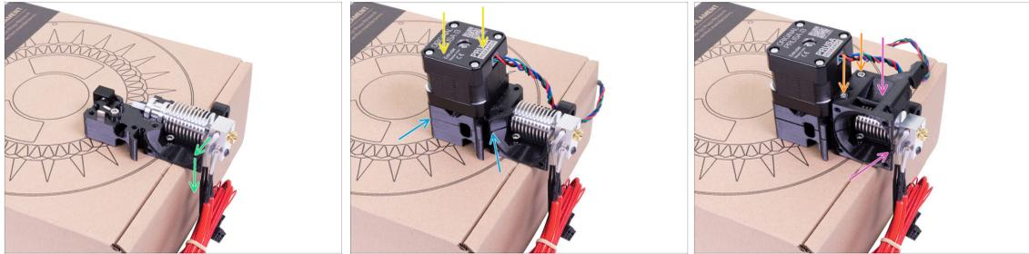
**⚠ Um die Hotend-Kabel zu schützen und eine korrekte Ausrichtung zu gewährleisten, wird dringend empfohlen, eine Schachtel zu verwenden. Verwenden Sie die im Kit mitgelieferte.**
