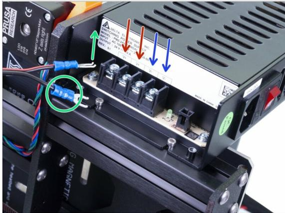
**⚠️ WARNUNG: Überprüfen Sie dreimal, ob Sie die Kabel richtig angeschlossen haben!!!** Es besteht die Gefahr, dass das Netzteil oder der Drucker selbst beschädigt wird, wenn die Kabel falsch angeschlossen oder nicht richtig angezogen sind!!!
