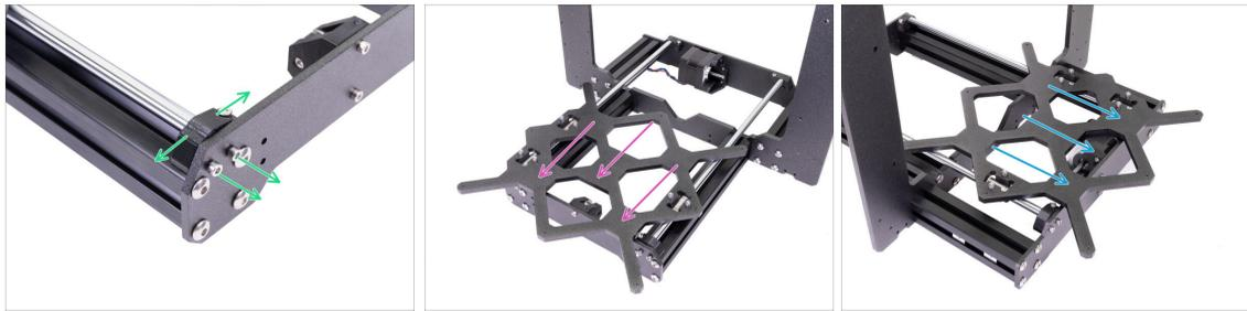
**⚠ WICHTIG:** Die korrekte Ausrichtung der Führungsstangen ist entscheidend für die Verringerung von Lärm und Reibung.
