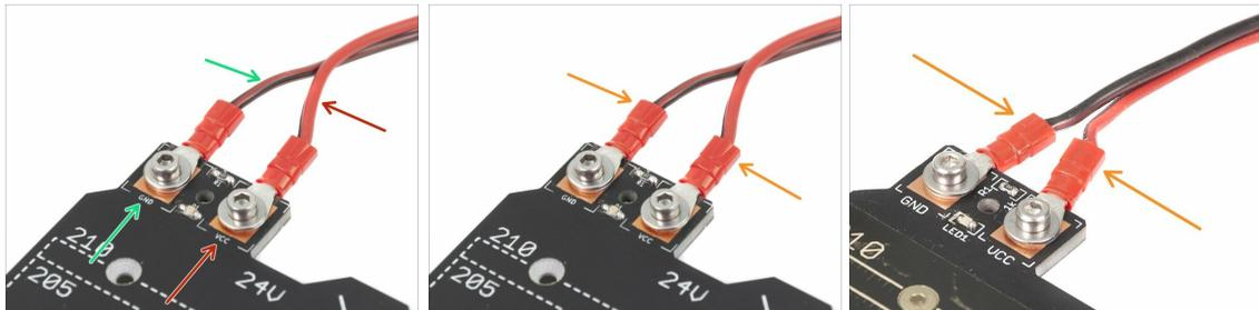
⚠ **Bevor Sie fortfahren, überprüfen Sie bitte noch einmal, ob das Kabel mit der richtigen Polarität an das Heizbett angeschlossen und richtig festgezogen ist. Andernfalls besteht die Gefahr einer Beschädigung des Druckers!**
