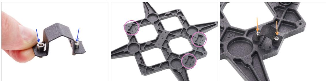
● Stecken Sie zwei M3x6 Schrauben in die Schraubenlöcher der Lagerklemme.
