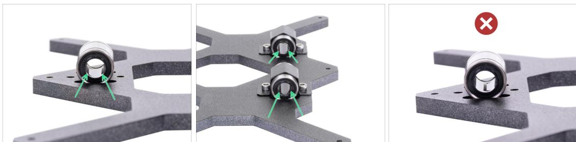
● **Die richtige Ausrichtung:** Achten Sie beim Aufsetzen der Lager auf den Y-Schlitten darauf, dass sie **so ausgerichtet sind, wie in den beiden Bildern gezeigt**. Die Laufbahnen (Kugeldreien) müssen sich an den Seiten befinden.
