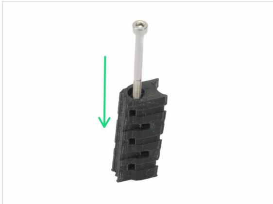
● Bereiten Sie die M3x40 Schraube und den Kabelhalter aus dem vorhergehenden Schritt vor.
