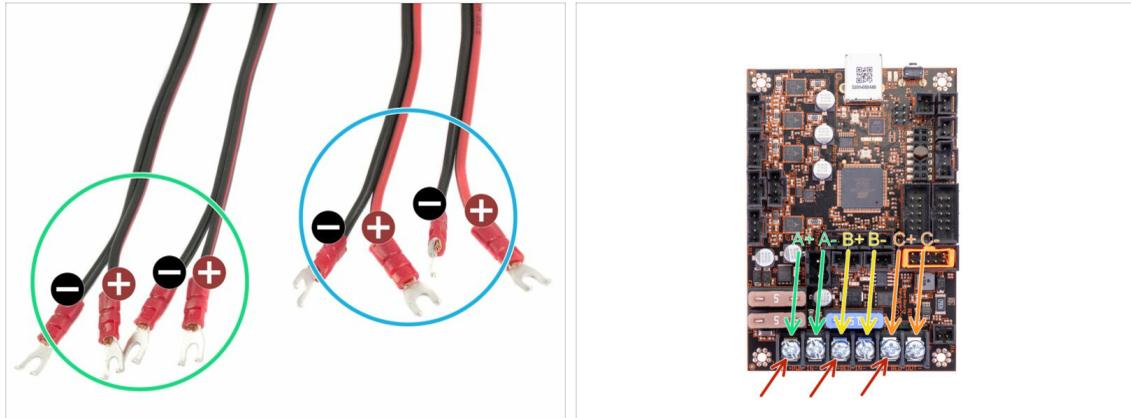
**⚠ WICHTIG:** Es ist **SEHR WICHTIG** das Netzteil und das Heizbett in der richtigen Reihenfolge am EINSY Board anzuschließen. Das **POSITIVE KABEL** muss am **POSITIVEN POL** des Boards angeschlossen werden. Es gibt **ZWEI VERSIONEN** der Kabel mit verschiedener Farbgebung:
