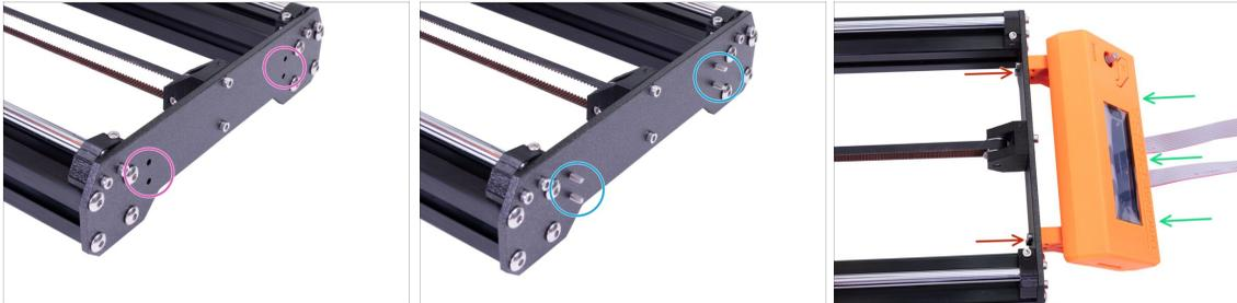
**⚠ ACHTUNG!!!** Falls Sie die schwingungsdämpfenden Stellfüße noch nicht angebracht haben, wird der vordere Teil des Druckers auf der LCD-Einheit zu liegen kommen. Befestigen Sie die Stellfüße jetzt, oder fahren Sie andernfalls sehr vorsichtig fort, da Sie die LCD-Halterung beschädigen könnten. Für die Montage gehen Sie zurück zu Kapitel 2 (Y-Achse).
