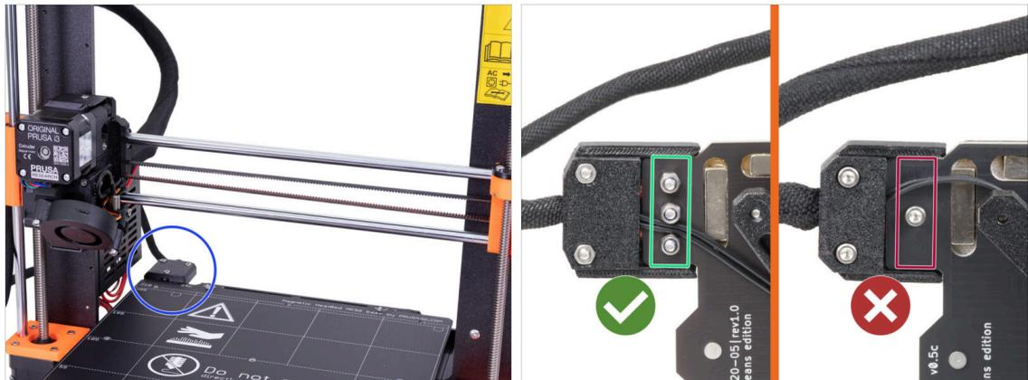
⚠ **La mise à niveau de la MK3S/MK3S+ vers la MK3.5S est compatible avec le plateau chauffant doté de câbles d'alimentation vissés.**
