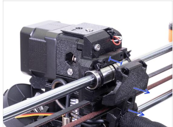
◆ Desserrez les quatre vis M3x10 sur le X-carriage-back. Vous pouvez les laisser dans la pièce imprimée.
