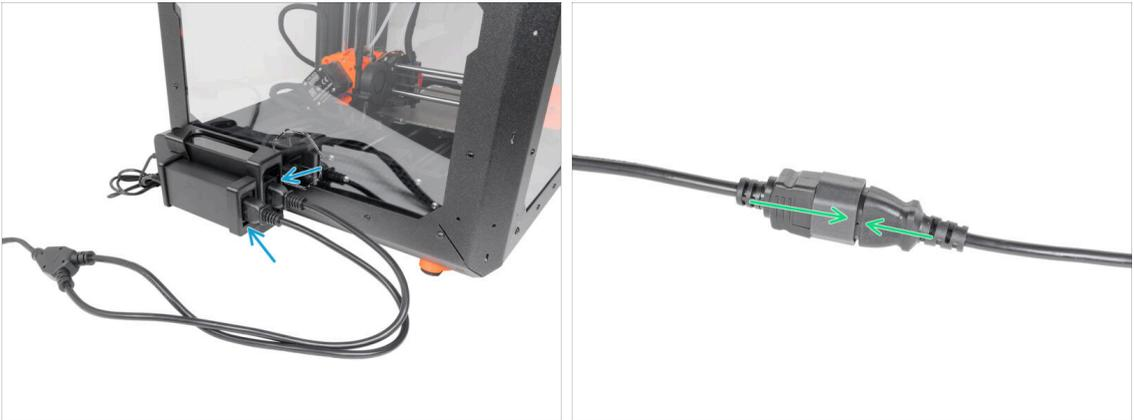
● Connectez les extrémités des fiches aux blocs d'alimentation.
