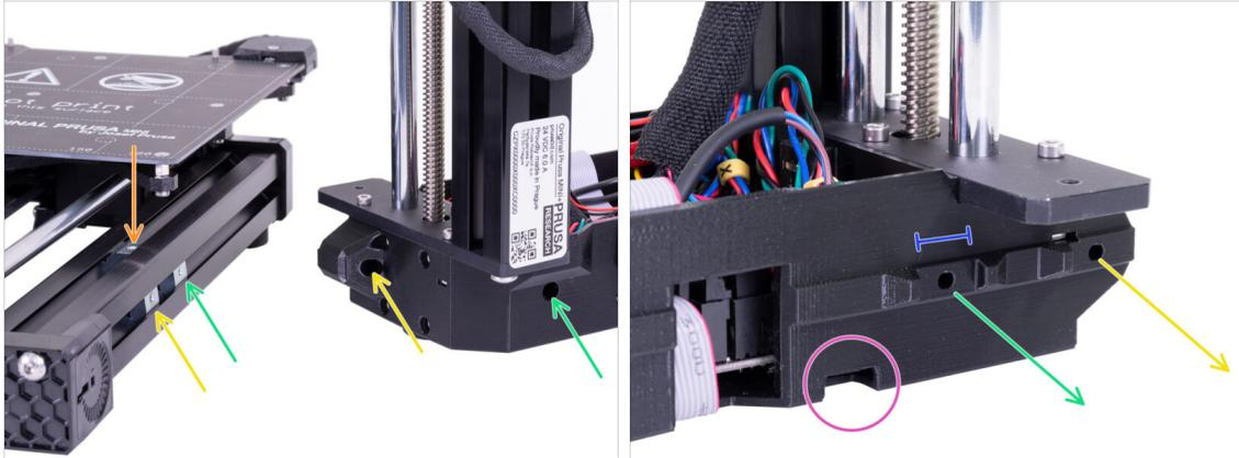
**⚠ IMPORTANTE:** Lee las siguientes líneas cuidadosamente. ¡Debes alinear las tres tuercas M3nE plateadas en el ensamble del eje Y con los agujeros de contraparte correctos en el ensamble del eje XZ!
